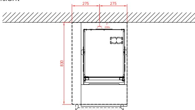
Der Fußbodenbelag muss **OHNE GEFÄLLE** eingebaut werden !!
