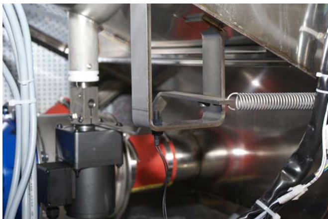
Abbildung 42: Korbantrieb mit Drehmomentstütze und Magnetsensor
