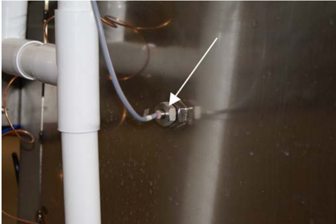
Abbildung 21: Haltebolzen des Temperatursensors
