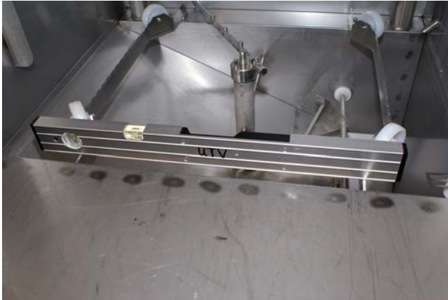
Abbildung 32: Nivellieren der Maschine – vorne.
