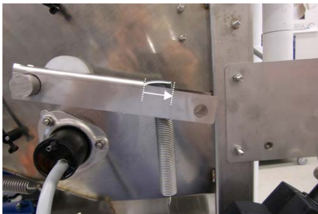
Abbildung 49: Dämpferschaftmechanismus nach dem Zusammenbau
