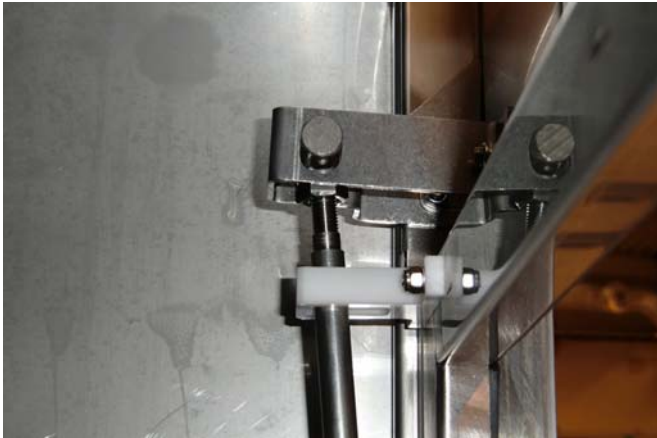
Abbildung 34: Stange mit Sicherheitsmutter, Gewinde für Anpassung.
