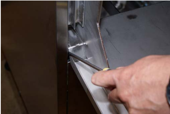
Demontage der Stangen von der unteren Tür
