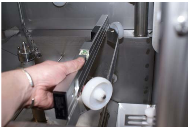
Abbildung 4: Nivellieren der Maschine – seitlich.
