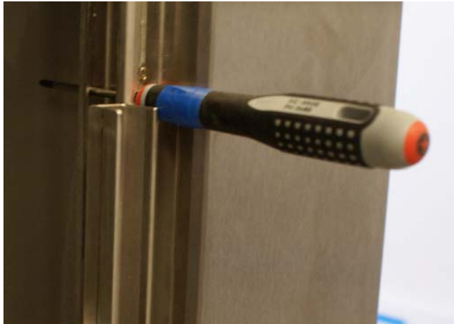
Abbildung 28: Fixieren der Tür mithilfe eines Schraubendrehers
