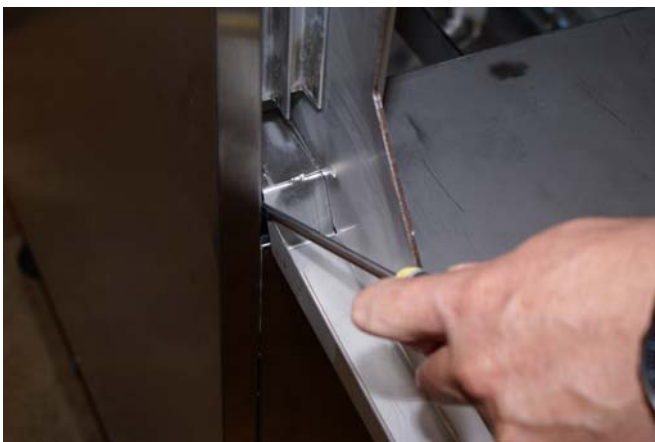
Demontage der Stangen von der unteren Tür
