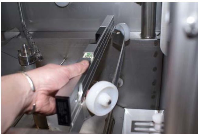
Abbildung 33: Nivellieren der Maschine – seitlich.
